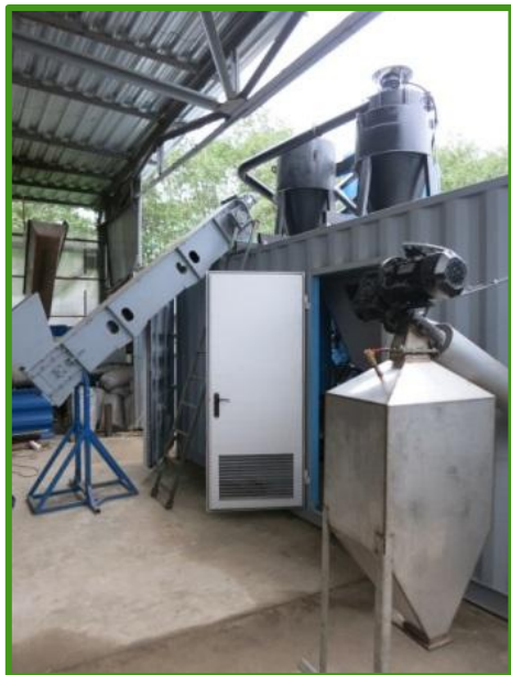
Конвейер подачи исходного сырья и бункер накопления высокоуглеродного материала
